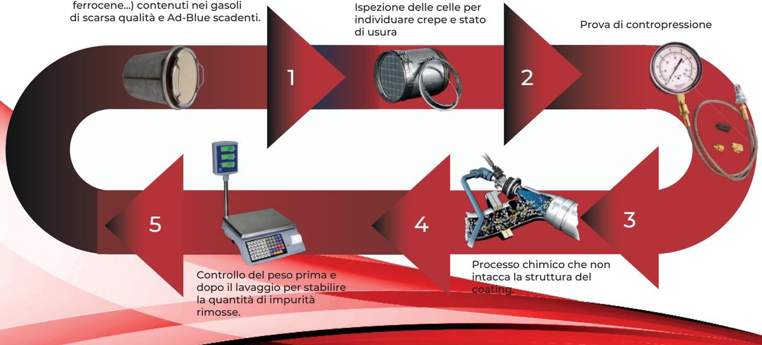
Rispetto ai competitor, il nostro macchinario non effettua una lavorazione a secco, ma un lavaggio ad alta temperatura con un processo chimico approvato dal CNR
